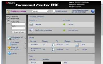
Имеется возможность удаленного доступа к аппарату для выполнения печати, отправки или загрузки данных. Администраторы могут задать настройки для управления аппаратом и его использования.
