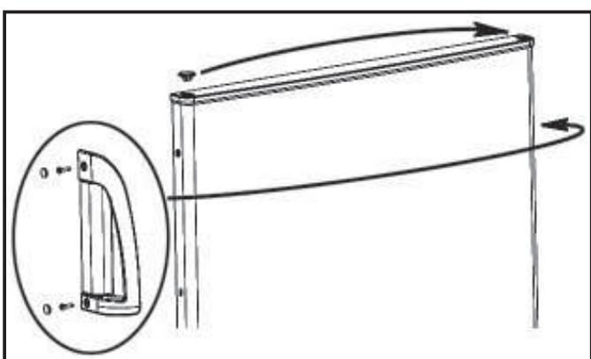
На накладках дверей холодильного прибора заглушки установить во втулки на противоположной стороне (справа). На ручках извлечь заглушки и, выкрутив винты, снять их.
