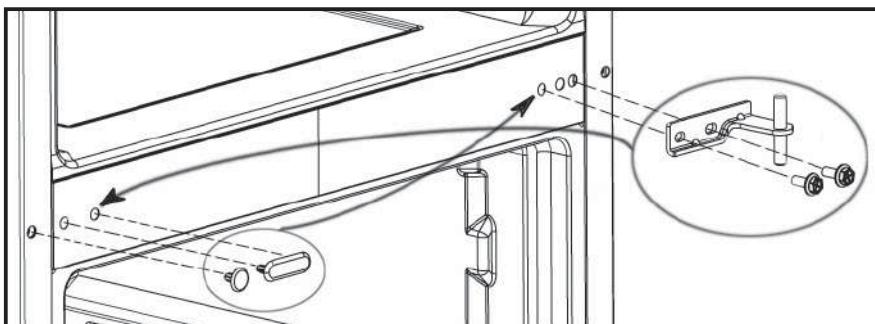
Извлечь накладку и заглушку из отверстий поперечины слева и установить их в отверстия справа, используя дополнительно заглушку из комплекта.
