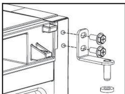
Придерживая верхнюю дверь, открутить болты крепления петли верхней, демонтировать петлю верхнюю совместно с шайбами регулировочными.
